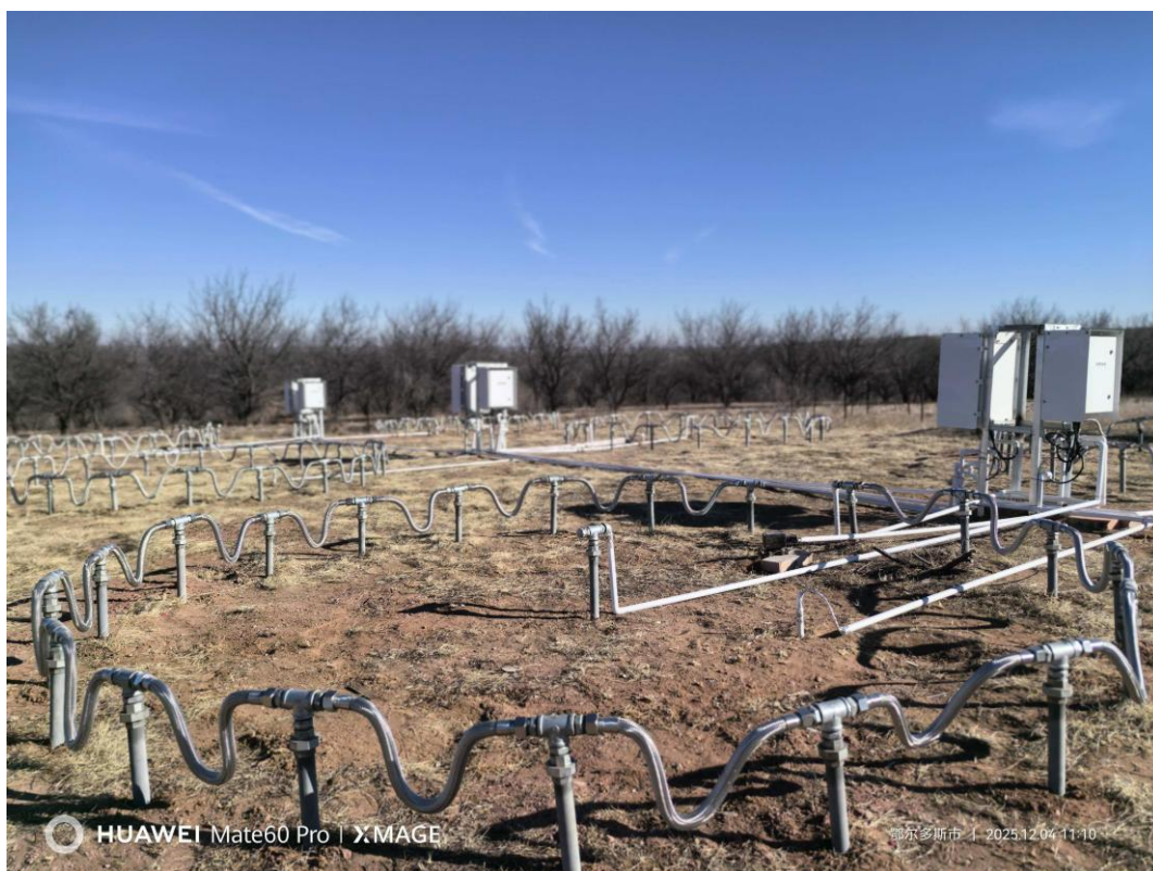
鄂尔多斯站草地生态系统土壤全剖面增温联网观测平台
