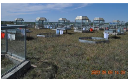
荒漠草原增温降水协同作用实验平台
