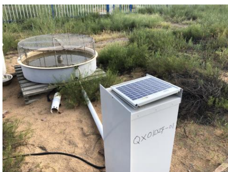
水面蒸发自动观测系统
