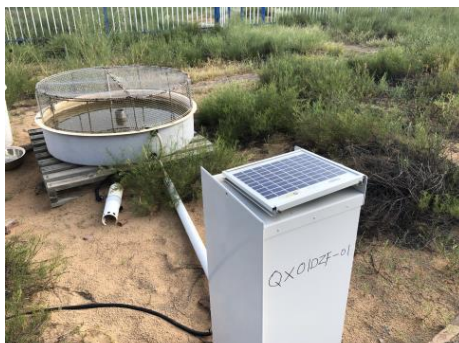
水面蒸发自动观测系统
