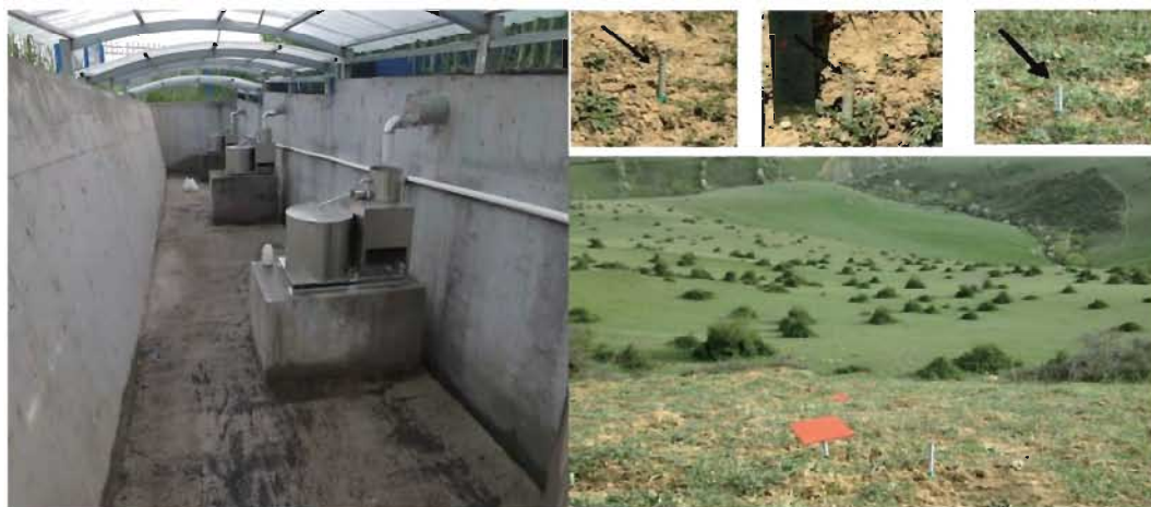
图3 径流泥沙监测系统（左）和微地貌高程变化测针监测（右）
