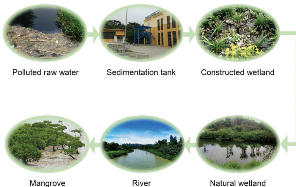
图 7. 深圳湾污水净化过程
