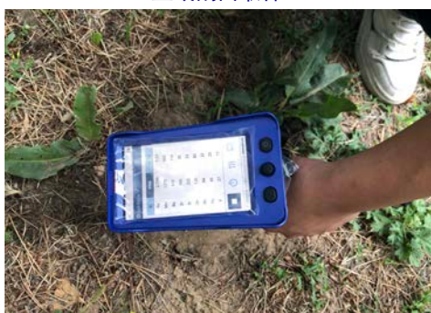
X 射线荧光光谱仪原位检测土壤重金属含量
