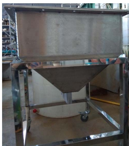
图 3.2 坡面岩石裂隙水土漏失过程模拟装置
