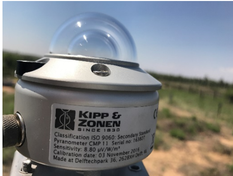
更换气象辐射传感器
