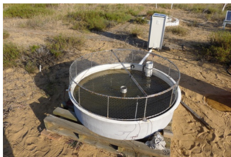
水面蒸发自动观测系统
