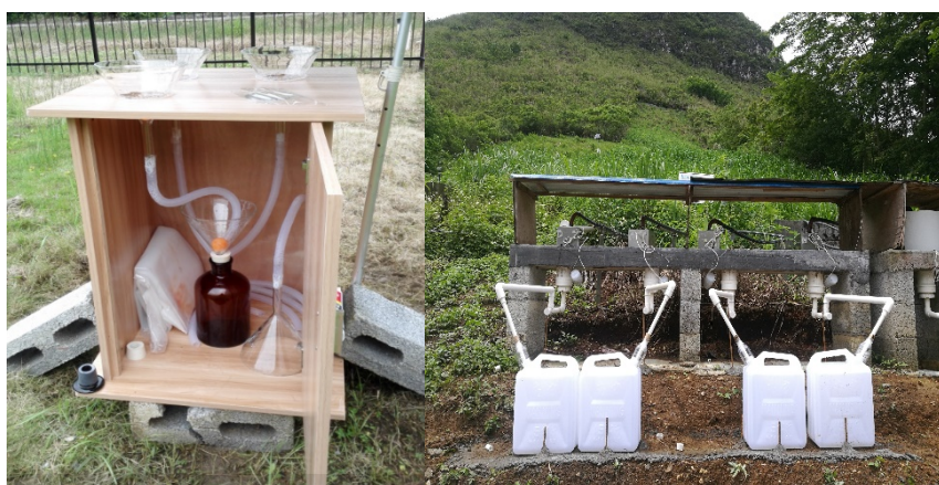
图 4.9 次降雨雨水收集装置；坡地地表产流和壤中流收集装置
