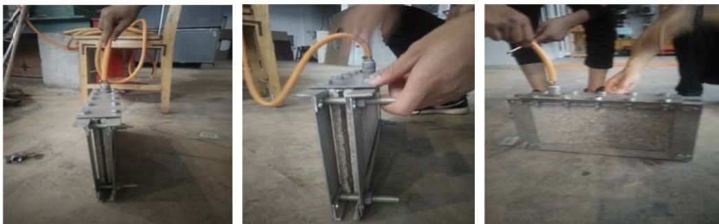
喀斯特峰丛洼地岩石裂隙水土漏失过程模拟试验装置
