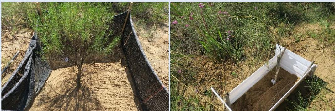
人工模拟土壤风蚀导致根系暴露
